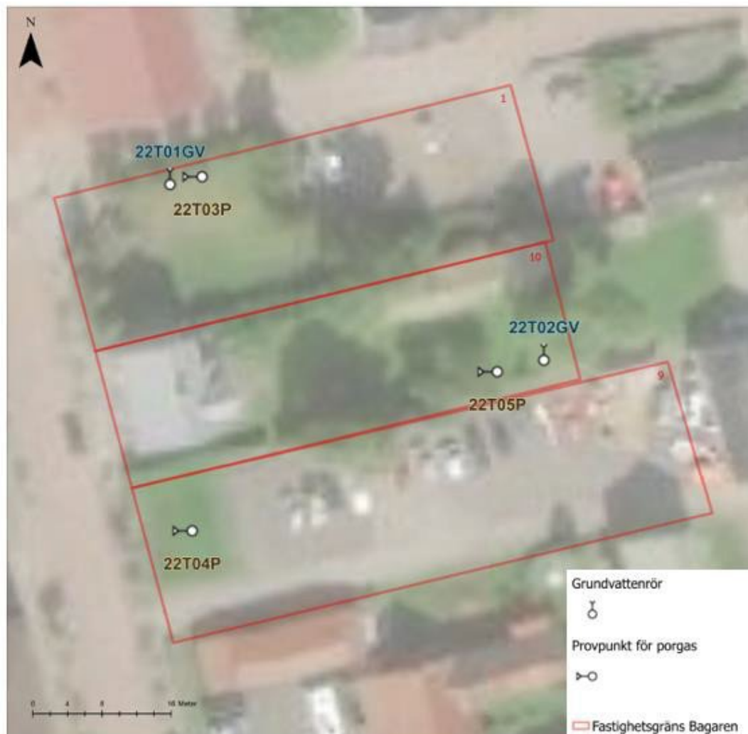
Bild 6: Utklipp ur dokument för miljöteknisk undersökning med planritning med provtagningspunkter.
